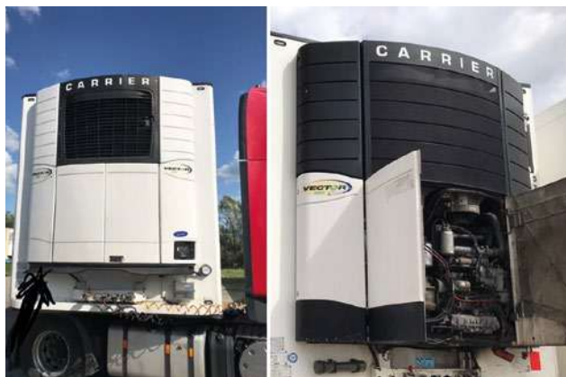
Rys. 5. Przykład agregatu ziębniczo-grzewczego umieszczonego na naczepie. Źródło: [7]
