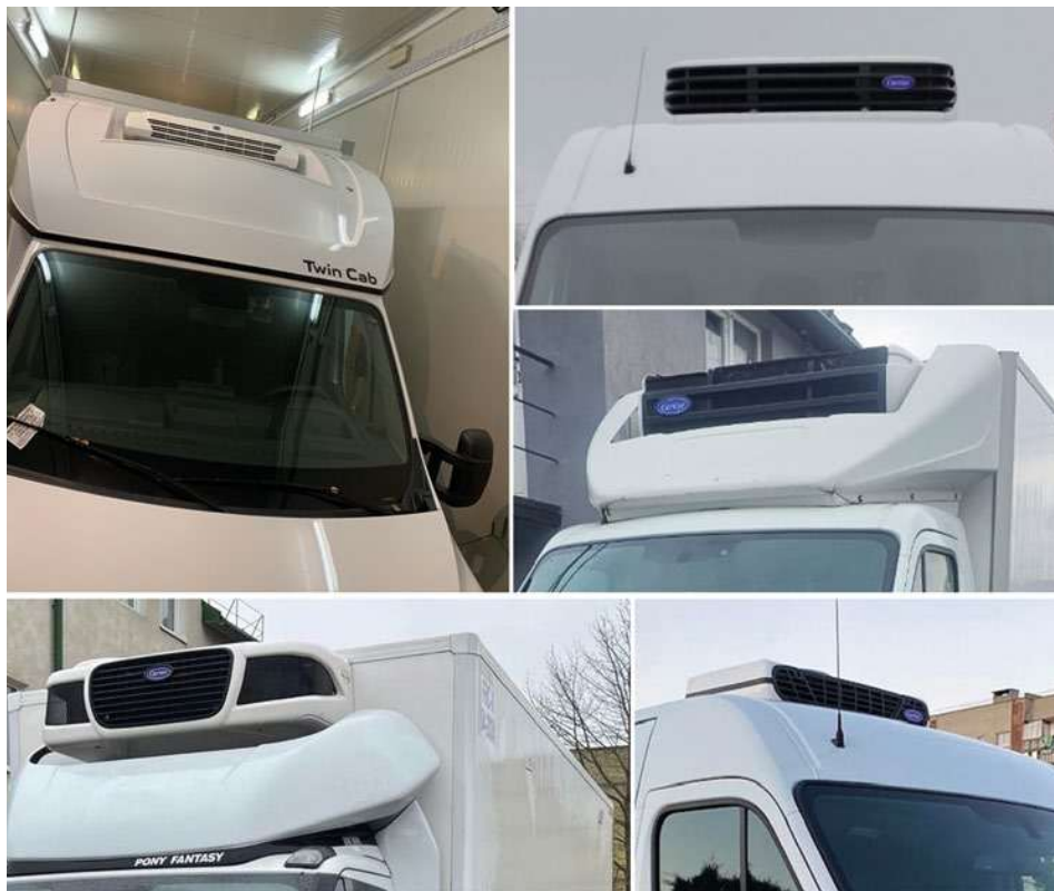
Rys. 8. Przykłady umieszczenia agregatów chłodniczych na izolowanych cieplnie środkach transportu. Źródło: [7]
