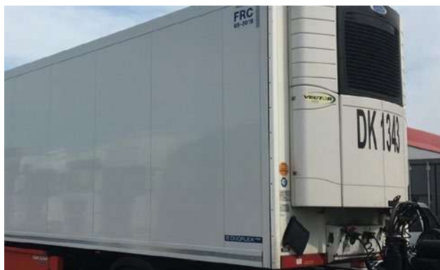
Rys. 6. Przykład izolowanego ciepłnie środka transportu wyposażonego w agregat ziębniczo-grzewczy. Źródło: [7]
