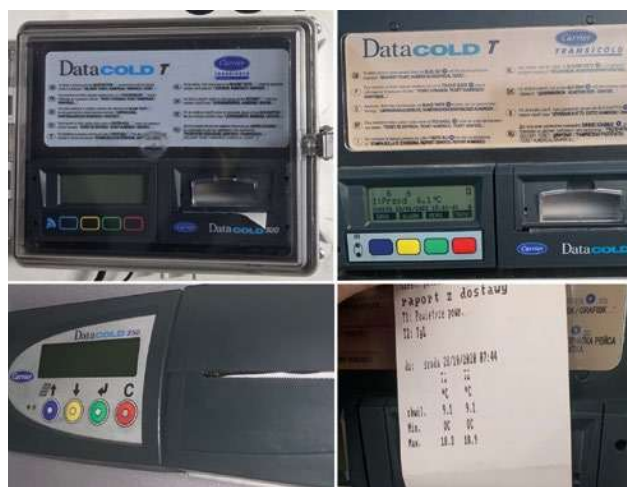
Rys. 7. Przykład rejestratorów temperatury zainstalowanych w izolowanych ciepłnie środkach transportu. Źródło: [7]
